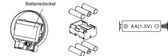
Ziehen Sie die Kabel ab und entfernen Sie den Batteriedeckel.
